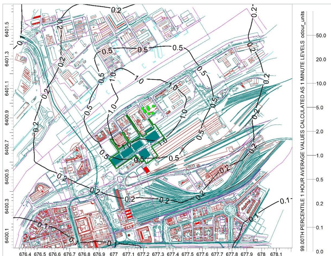
Figur 11 Luktspredningen när utsläppet från kvarnen är borta och med 90 % rening av utsläpp från aspiration och aspirationsfläkt. Lukthalter vid inandningsnivå 1,5 m över mark.
